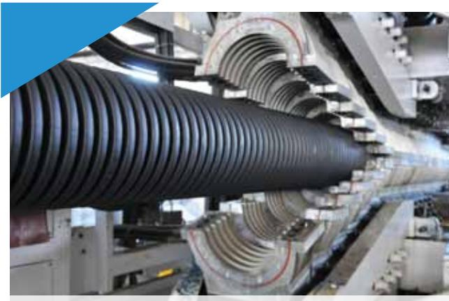
Parte a procesului de fabricație automatizat a țevilor corugate EuroEm
